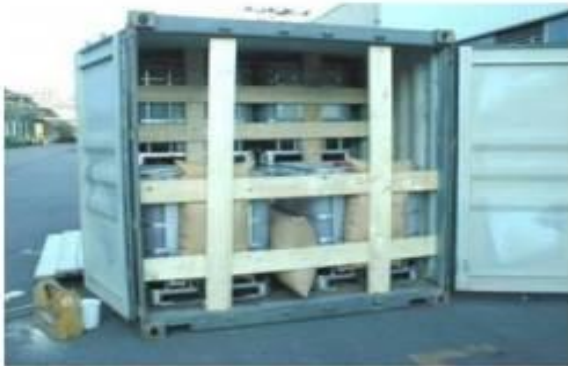
Hình 5.2. Minh họa về các thùng hàng tải trọng trung bình được chèn đôi trong công te nơ
